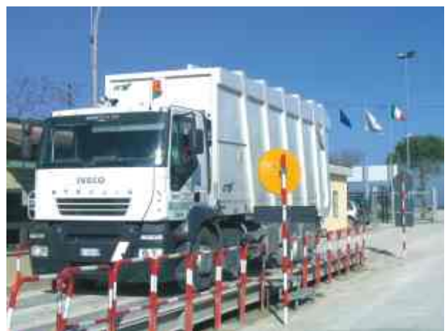
Figura 9 ingresso e uscita automezzi e sistema di pesatura
